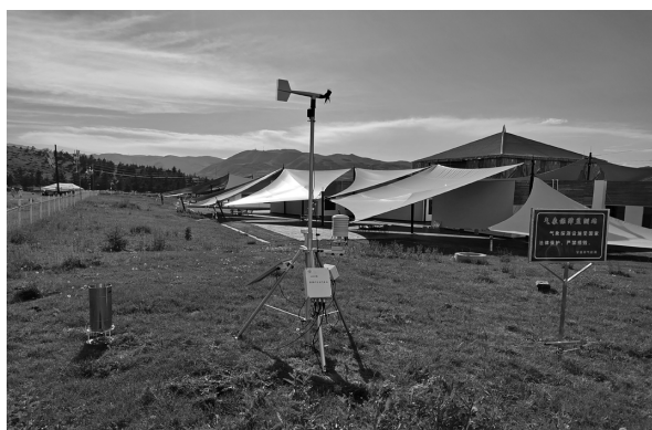
2023 年 8 月，在当周生态文化旅游区架设 6 要素便携式自动气象站
